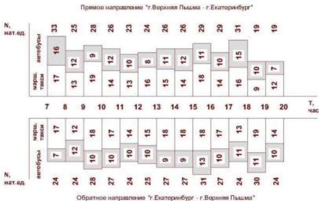
Рис.2. Количество автобусов пригородных маршрутов и маршрутных такси, совершающих пассажироперевозки в сечении по пр. Успенскому (г. Верхняя Пышма) по направлениям и часам суток
